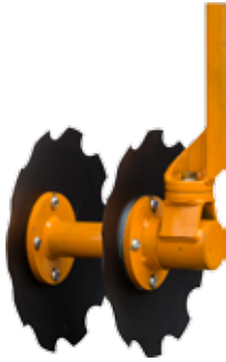
doppelter Tellerpflug, Arbeitsrichtung gegen Baumreihe doppio disco dentato, direzione di lavoro contraria rispetto alla fila di alberi double notched disk, working direction against tree row
