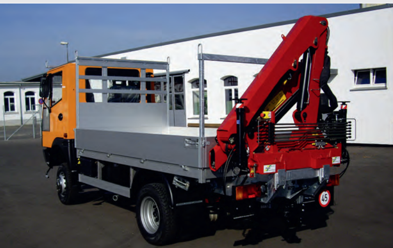
MT720 mit Brücke und Heckkran
